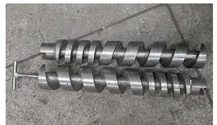
**Рис. 2.** Двухвинтовой вытеснитель фарша:
